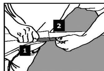
**Réglage du mousqueton :** C'est très facile ! Positionner le mât et la voile comme ci-dessus. Maintenir la tension de la voile avec une main **1** et de l'autre main régler la patte velcro **2** . Presser fortement.
