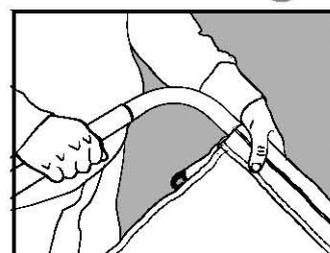
► **Fixer le mousqueton** de la voile sur le pontet existant du tube, **A** et ajuster si nécessaire\*
